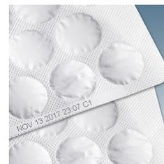
**Código de inyección de tinta térmica sobre láminas de blíster**
